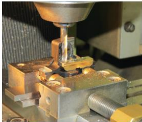
... nicht präzise genug, so wird eben aufgefüttert und plangefräst.
